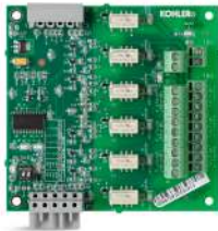
Standard I/O Module
